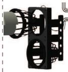
W125 × H250のジョイントパネルを組み合わせる事で壁面やタワー型躯体を制作する事が出来ます。ジョイントパネルはLアングルなどの鉄材にネジで固定し、灌水チューブを配管する事で植物を装飾する躯体となります。
